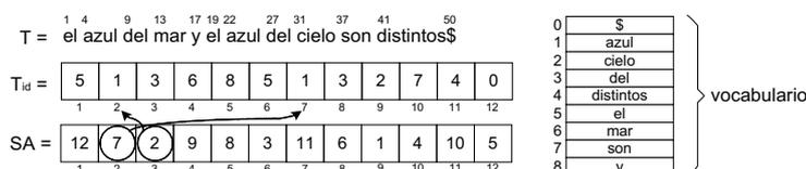
**Figura 1.** Estructura de un SA orientado a palabras.
