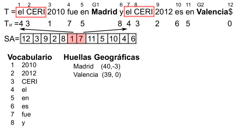
Figura 1. Ejemplo de array de sufijos orientado a palabra (WCSA). En esta figura adelantamos que las referencias o huellas geográficas reciben un tratamiento especial, por lo que no se indexan en el array de sufijos SA.
